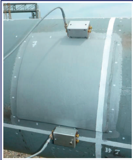
Figura 8. Sensores SH con imanes permanentes posicionados a ambos lados de un refuerzo
