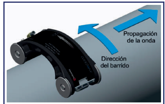
Figura 11. Sensor magnetostrictivo y escaneo circunferencial
