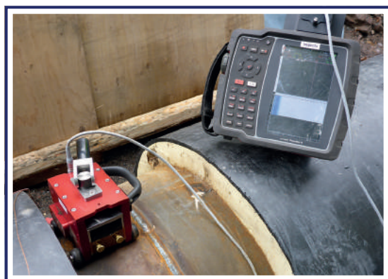
Figura 7. Configuración del escáner MRUT para inspección circunferencial de tubería
