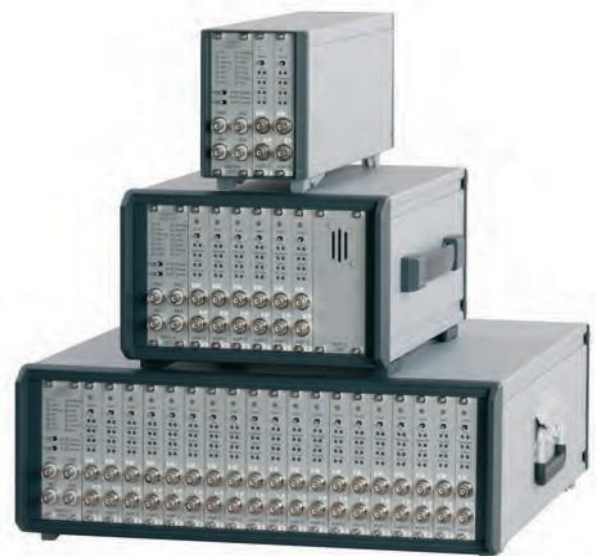
AMSY-6 chasis MB2, MB6 y MB19, caja de 4, 12, 38 Canales respectivos de EA
